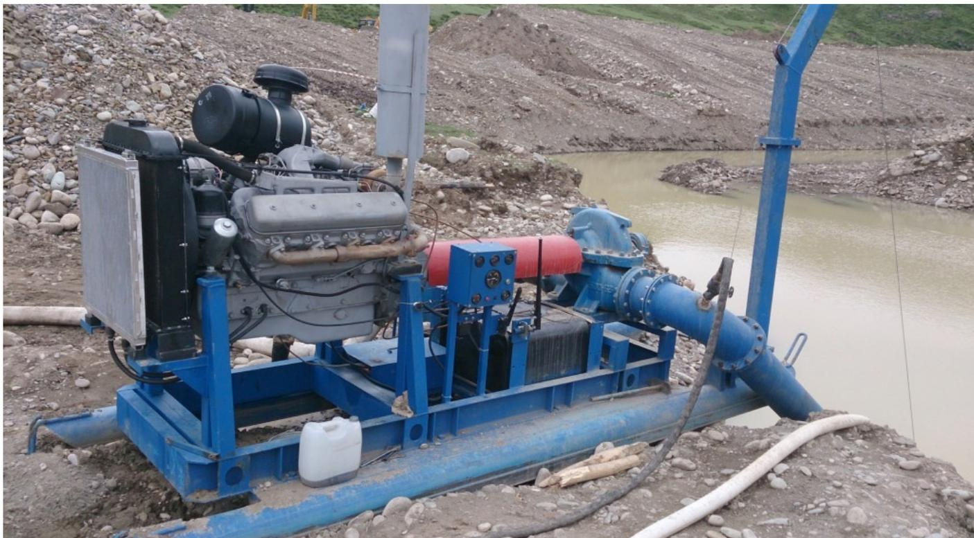
Рис. 5. Передвижная насосная станция
