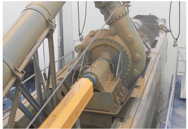
Рис. 2. Трюмное расположение грунтового насоса
