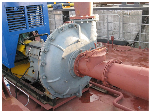
Рис. 4. Грунтовый насос расположен на палубе земснаряда
