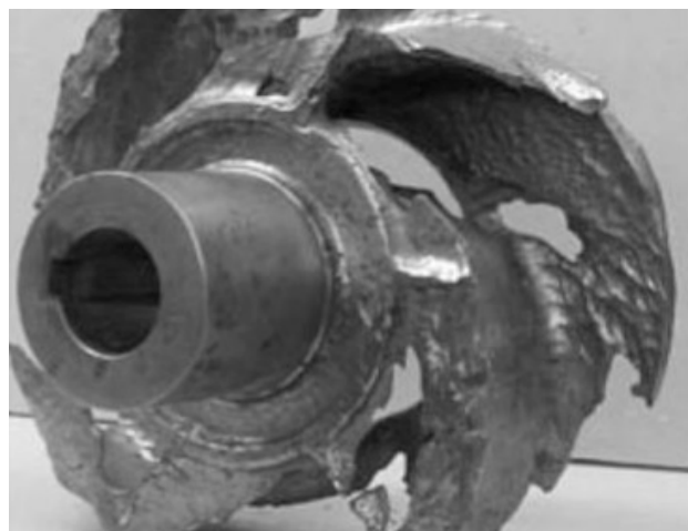
Рис. 5. Запредельный абразивный износ рабочего колеса, не подлежащего восстановлению
