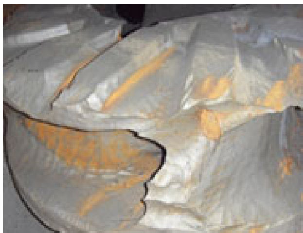
Рис. 4. Абразивный износ рабочего колеса грунтового насоса
