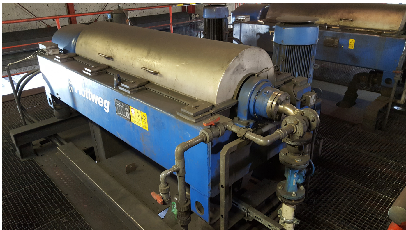
Рис. 4. Декантер Flottweg Z4E-4/451 на доменном производстве завода ArcelorMittal, Айзенхюттенштадт (Германия)
