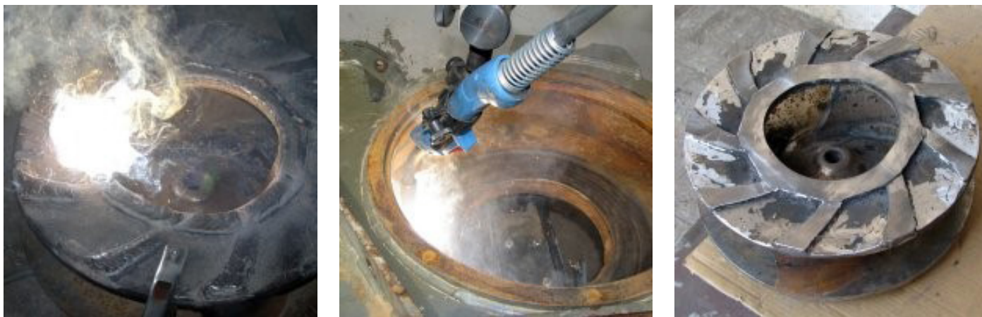
Рис. 6. Восстановление деталей грунтового насоса электродуговой наплавкой
