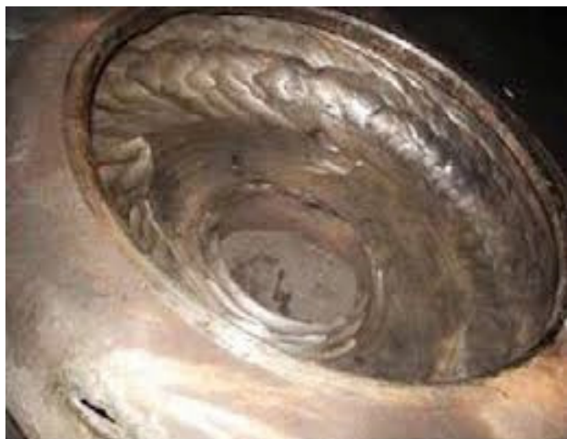
Рис. 4. Абразивный износ рабочего колеса грунтового насоса
