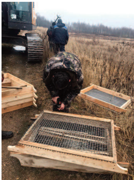
Рис.4. Сита для полевого рассева песчано-гравийных пород
