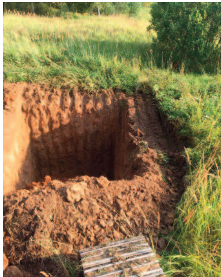
Рис.2 и 3. Проходка шурфа на месторождении валунно-гравийных пород
